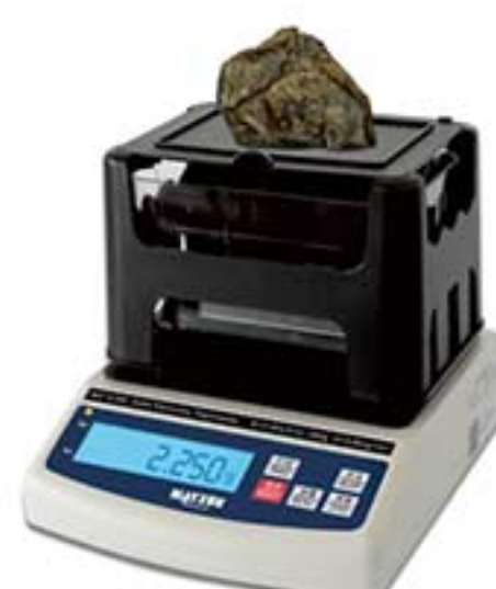
MZ-Z300 岩石体积 密度、吸水率测试仪
