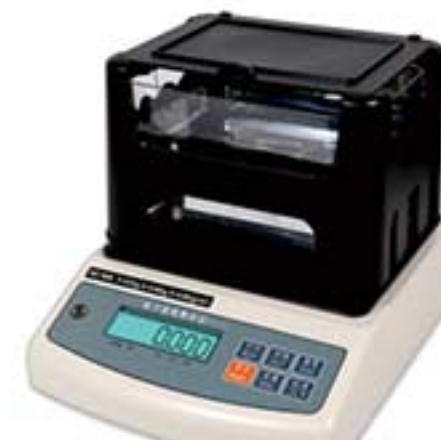
MZ-I600 磁性材料专用密度、吸水率测试仪
