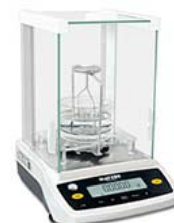
MAY-Entris120 智能型多孔海绵体积密度、吸水率测试仪
