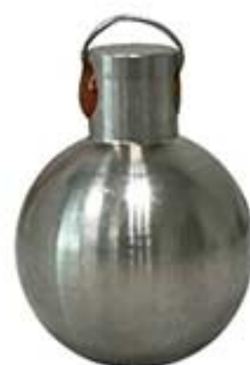
5. 不锈钢标准块 (高粘稠液体测试用)
